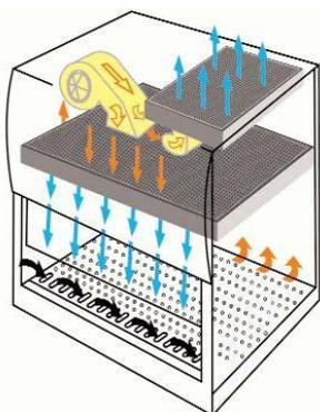
L'aria decontaminata dal filtro assoluto scende con flusso laminare sull'area di lavoro, ne attraversa il piano, si miscela con l'aria esterna, che penetra nella cabina attraverso l'apertura frontale, nella zona anteriore del piano di lavoro.
